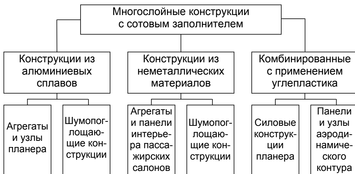
Рис.3.17. Классификация многослойных конструкций с сотовым наполнителем
